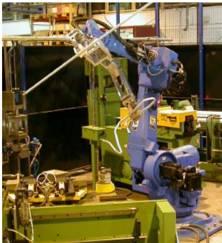
En robotcell på EMA för automatisk ändformning, håltagning och bockning.
